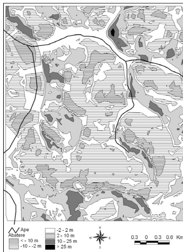
Fig. 2. Diferența dintre modelul generat din SRTM și modelul generat din curbele de nivel ale hărții
